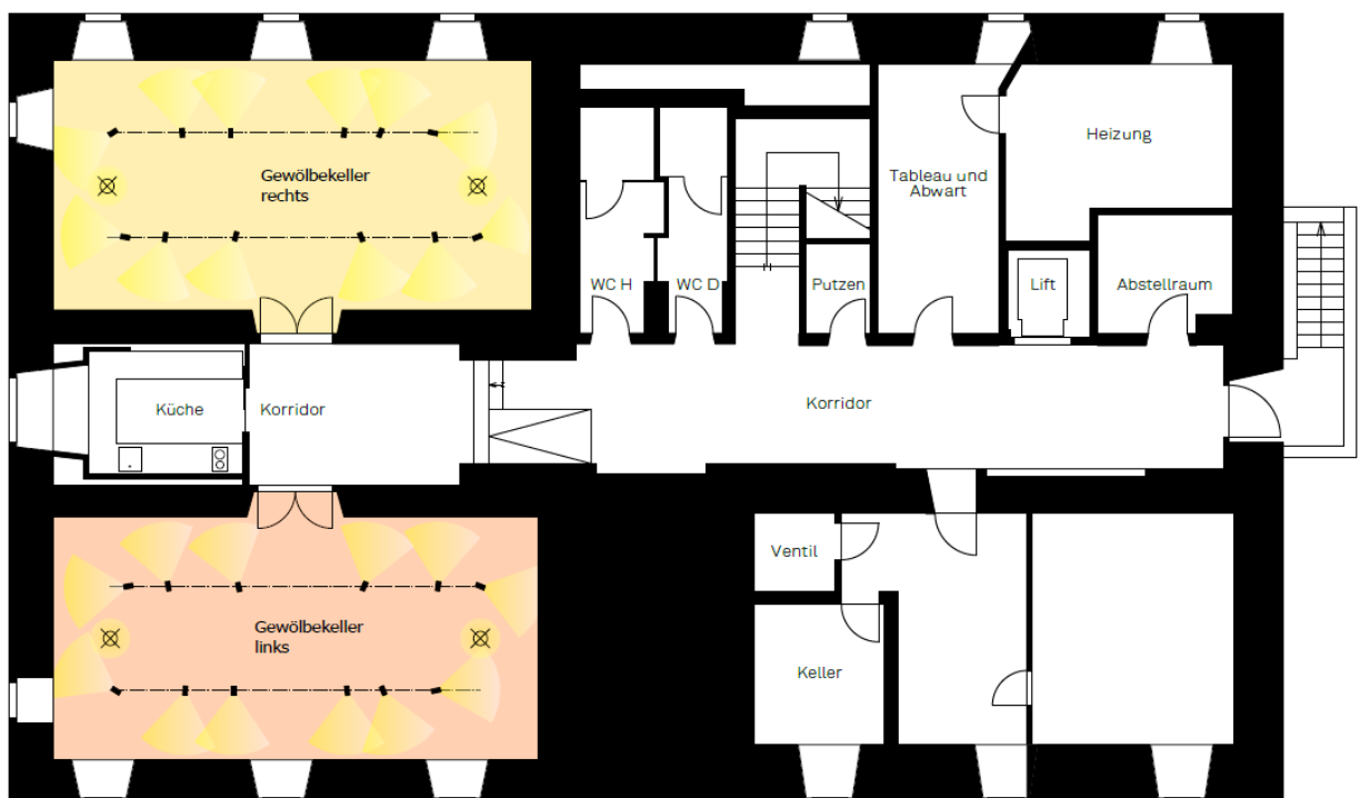
Plan Gewölbe (links rot eingefärbt)
